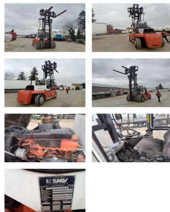
**L'équipement spécial et accessoires:** Tabliers à déplacement latéral, Positionneur de fourches, Cabine complète, Pneus jumeaux,
