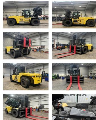
**L'équipement spécial et accessoires:** Tabliers à déplacement latéral, Positionneur de fourches, Cabine complète, Climatisation,
