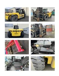
Adjuntos y Equipamiento adicional: Desplazador lateral, Posicionador de Horquillas, Cabina integral, Aire acondicionado,
